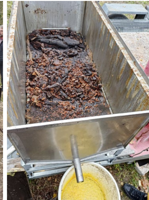
Sulatusaltaan pohjalla on siivilänä metalliritilän päälle asetettu säkkikangas. Sula vaha valuu putkesta edessä olevaan ämpäriin.
