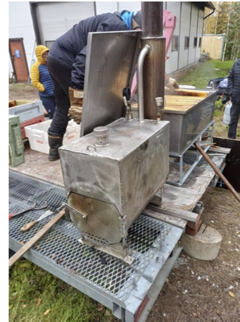
Kuvassa höyrykattila ja takana sulatusallas, jonne höyry johdetaan.
